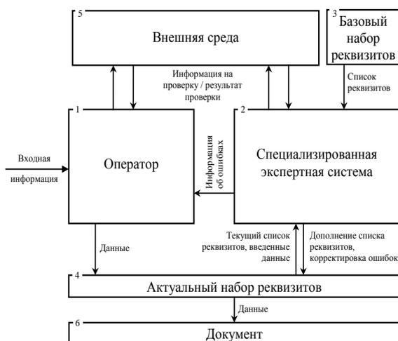
**Рис.** Концептуальная схема работы метода динамической адаптации интерфейса пользователя на основе вводимых им данных
